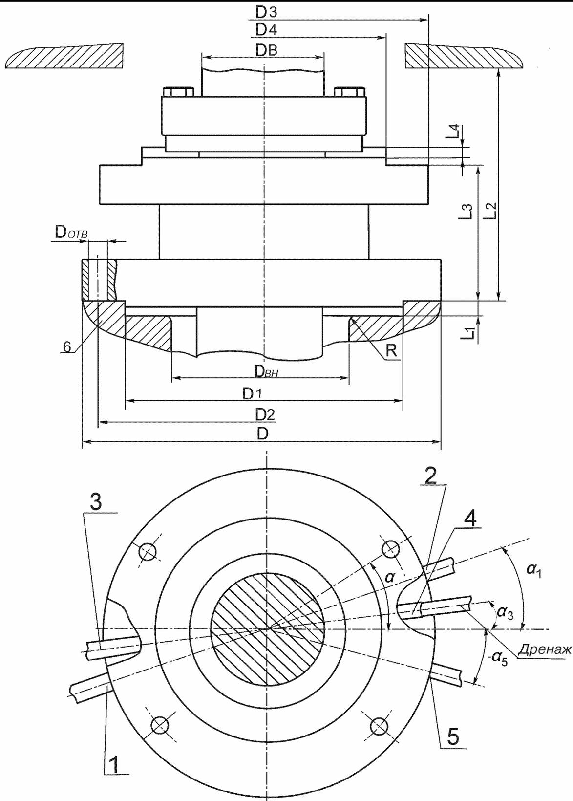
1. Штуцер входа затворной жидкости
